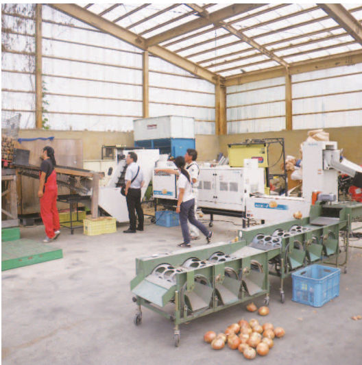
▲試運転の様子 中央の白い機械が新たに導入した調整機
