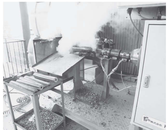
稼働中のグラインドミル 右側のタンクからもみ殻が供給され、モミガライトが左側へ押し出され、自動で切断される。
