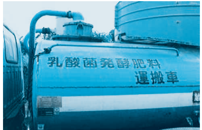
液肥を運搬・散布する車両
