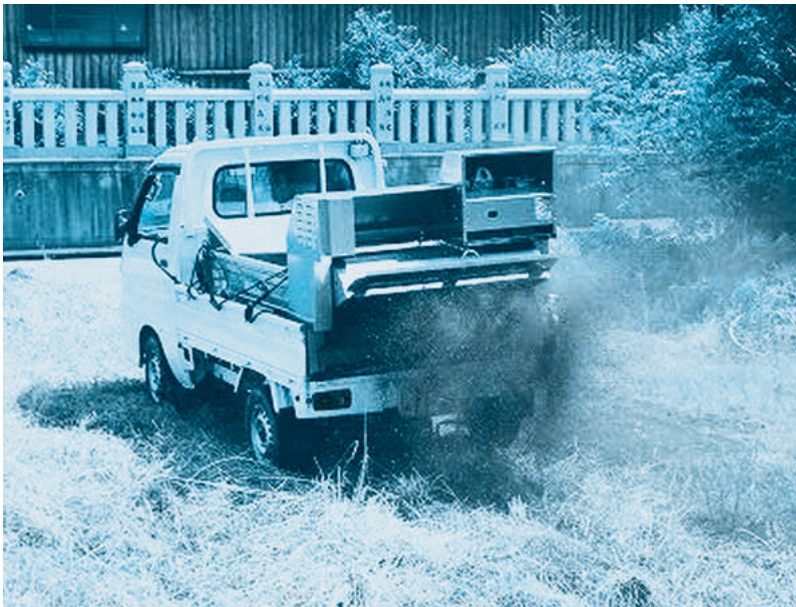
図ー2 軽トラ搭載型マニアスプレッダーによる堆肥散布実演の様子 ※散布している堆肥は三郷堆肥センターの商品を持参し、実際に散布する場合と条件を同じにした。
