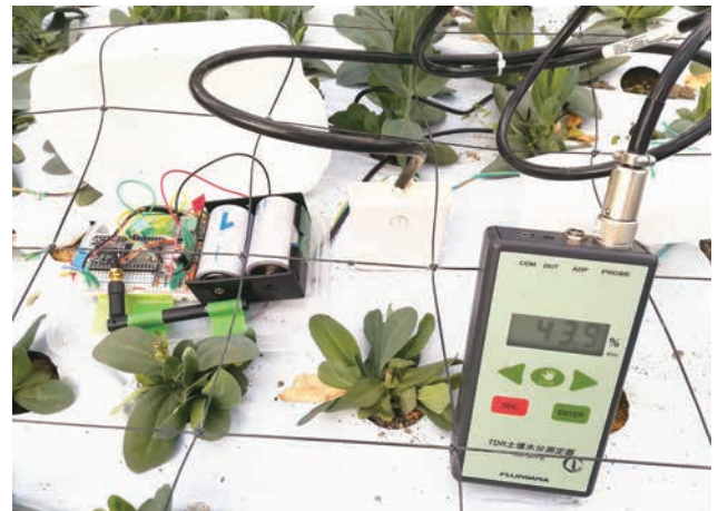
図2 設置時に比較で使用したTDR土壌水分計
