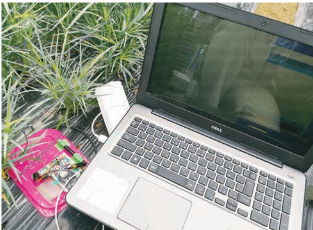
図1 土壌水分センサーの校正
