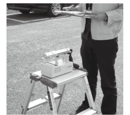
●測定機器 シンチレーションサーベイメータ「TCS-172B」(日立アロカメディカル株式会社)
