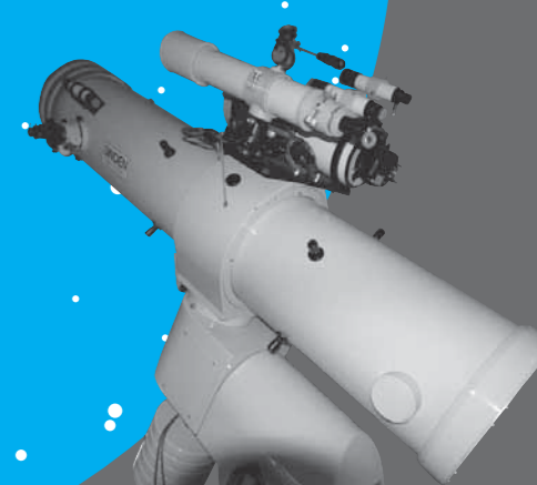
天平の森に設置されている 400ミリニュートン式反射望遠鏡
