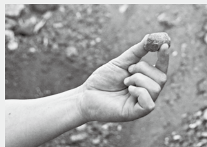
1日10 ト ほどの埋立ごみが発生。焼却灰は薬剤で固められ、「固化灰」として最終処分場まで運ばれます。
