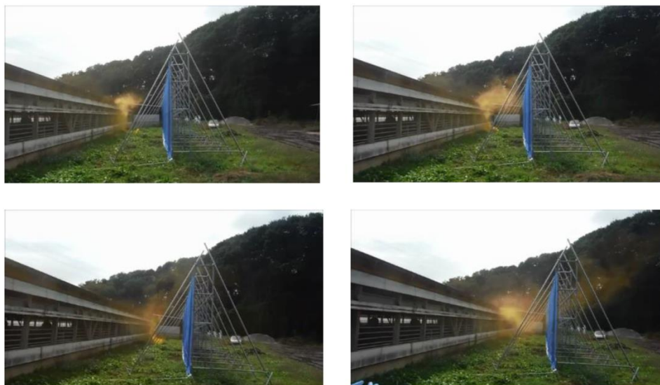
写真1 発煙筒による臭気の流れ
