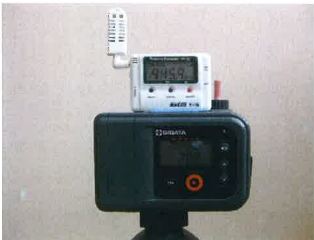
捕集ポンプ及び気象データロガー
