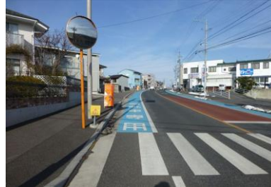
車道にカラーリングをして自転車通行帯の表示した例（長野市）
