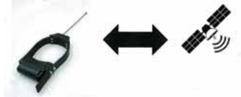
GPS 発信機：衛星を利用した滞在位置特定 サル滞在位置を自動的に記録
