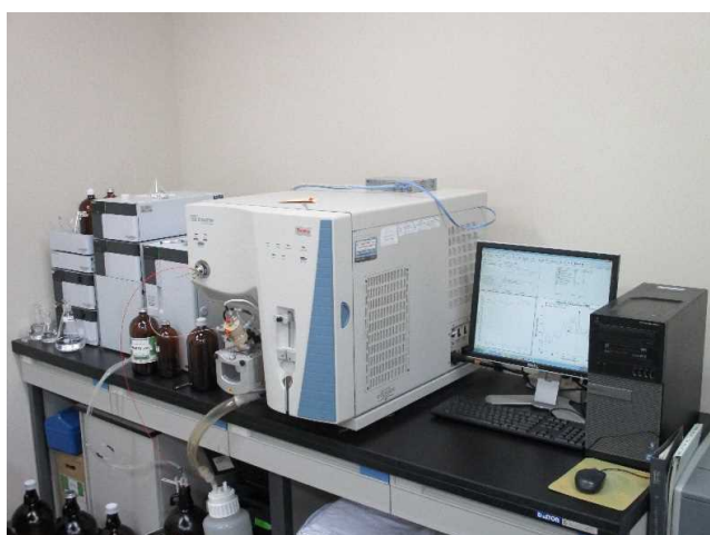
分析装置 (高速液体クロマトグラフタンデム質量分析計)
