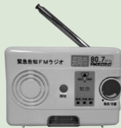
緊急告知 FM ラジオ (長岡市)
