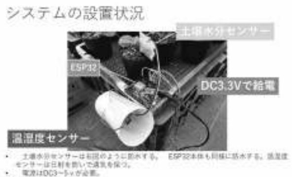
図2 システムの設置状況 (ハウス内)
