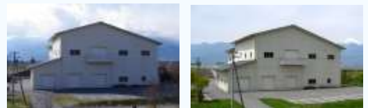
光の当たり方によって色の見え方が変化する ⇒明度の高い大規模な平滑面は光の影響を特に受けやすい。壁面の分節化によって陰影を付け、圧迫感を軽減することができます。（p.15 参照）
