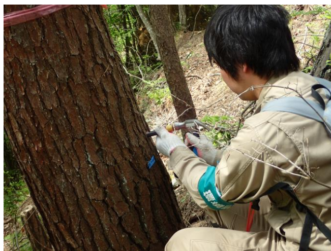
小田式診断法（皮ポンチ法）の様子
