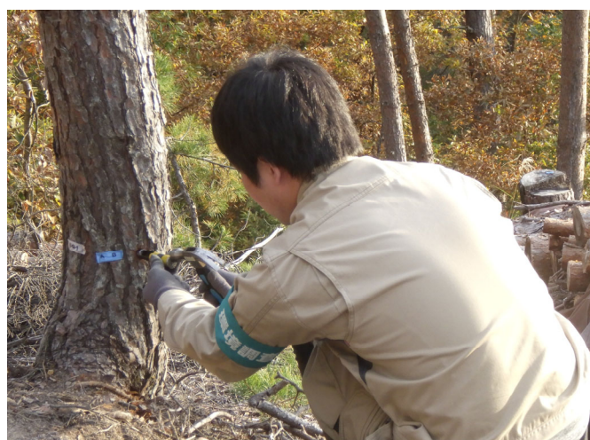
小田式診断法（皮ポンチ法）の様子
