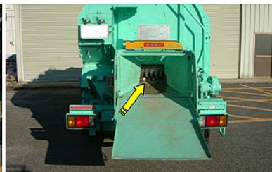
投入口が狭いので、葉をできるだけ取り、枝分かかれは切り揃えてから出してください。
