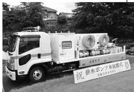
披露された排水ポンプ車
