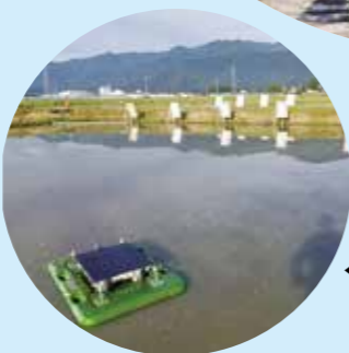
▲走行することで田面を濡らせるリモコン式のロボット
