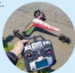
▲走行することで田面を濡らせるリモコン式のロボット
