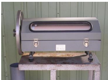
ドラム式自記水位計 (地下水位12箇所うち4箇所設置)
