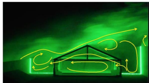
図1 模型による気流の可視化試験
