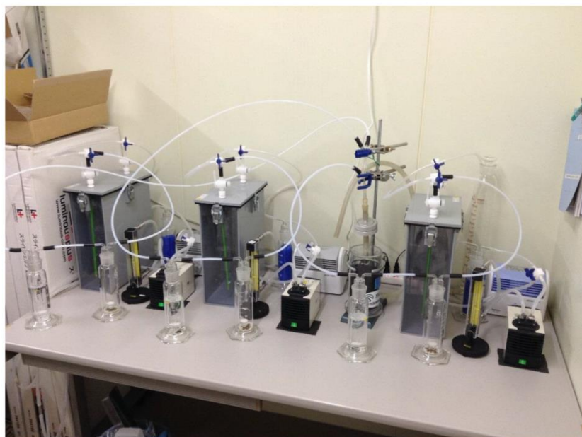
写真 1 臭気対策資材の効果判定装置の外観（3 台）
