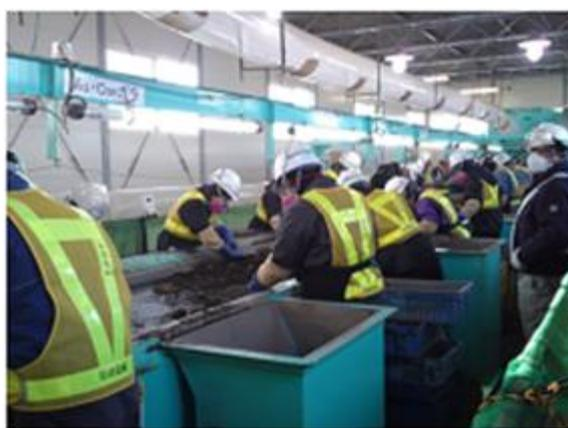
仮設処理施設内の手選別工程
