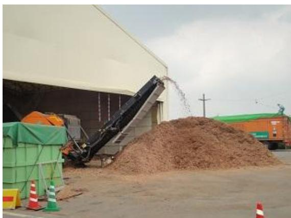
仮設処理施設での木くずの破碎
