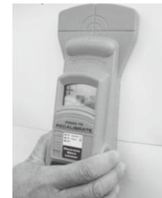
鉄筋探査機
