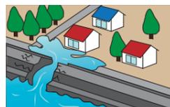
堤防に水が過度に浸み込んだり、堤防が河川の流れにより浸食されて(削られて)堤防が決壊し水があふれ出します。
