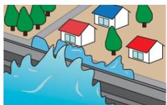
増水した河川の水が堤防の高さを越えて街中にあふれ出します。
