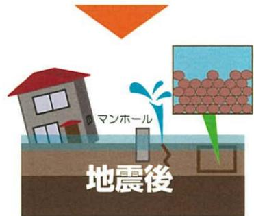
バラバラになった砂の粒子が沈むため、地面に水が出てきたり、地面の裂け目から砂交じりの泥水が噴出します。
