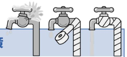
**例** 年、12月から3月にかけて凍結による水道メータの破損が多く発生しています。急な寒波などで、気温が氷点下4度以下になると水道管が凍ったり、破裂したりします。冬期には必ず水道管などの防寒を心掛けてください。
