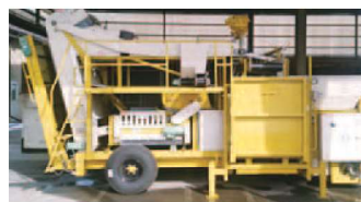
▲①根切り葉切り機（土を払い、葉や根を切り落とします）
