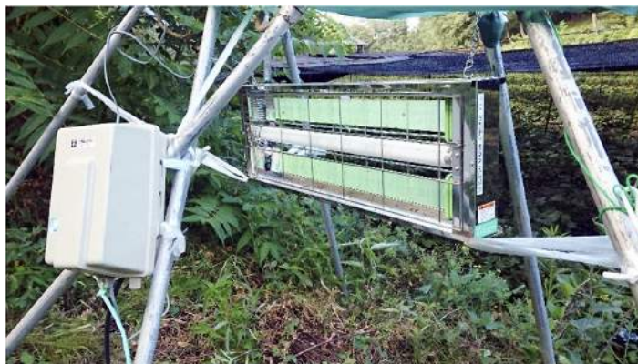
写真1 わさび園脇に設置したUVランプ
