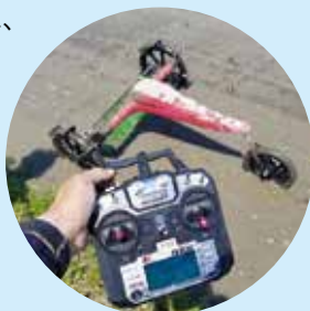
▲走行することで田面を濁らせるリモコン式のロボット
