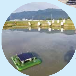
▲走行することで田面を濁らせるリモコン式のロボット
