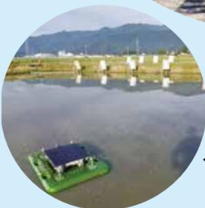
◀自動航行プログラムで、水面に浮いた状態で除草するロボット
