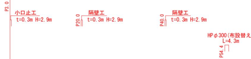
※隔壁工は20m程度に1箇所設置
