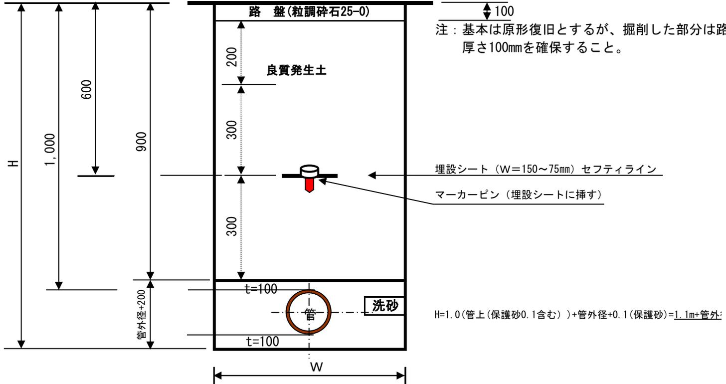
県道掘削復旧標準図 1 ( 車道部 舗装 ・ A交通)
