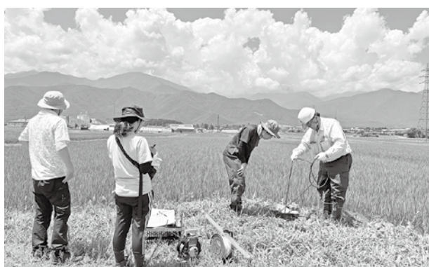
地下水調査の様子(観測用の井戸で地下水位を測定)
