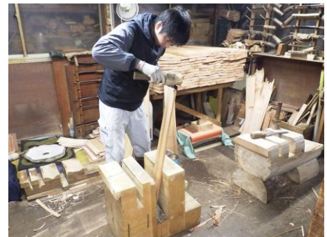
曽根原家住宅の屋根材更新のための へぎ板の加工
