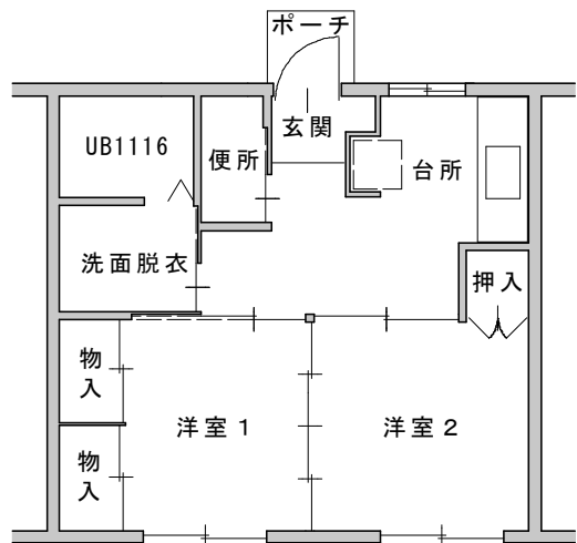
昭和46年度建設 簡易耐火構造平屋建 9~12号
