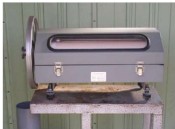
ドラム式自記水位計 (地下水位12か所うち4か所で設置)
