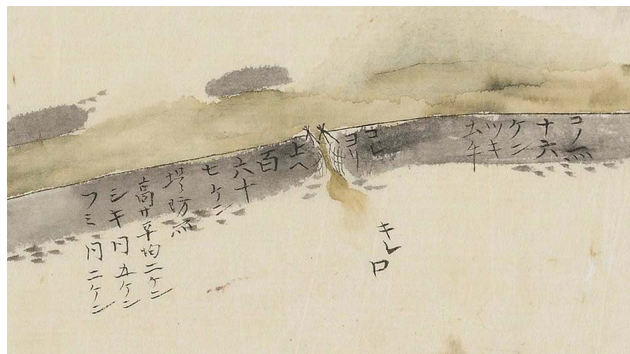
上図□部の拡大図 「コノ所十六ケンツキ土手」「コレヨリ上へ百六十七ケン 堤防所高サ平均二ケンシキ同五ケンフミ同二ケン」
