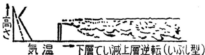
図3 下層でい減上層逆転（いぶし型）と煙突排煙の拡散の形
