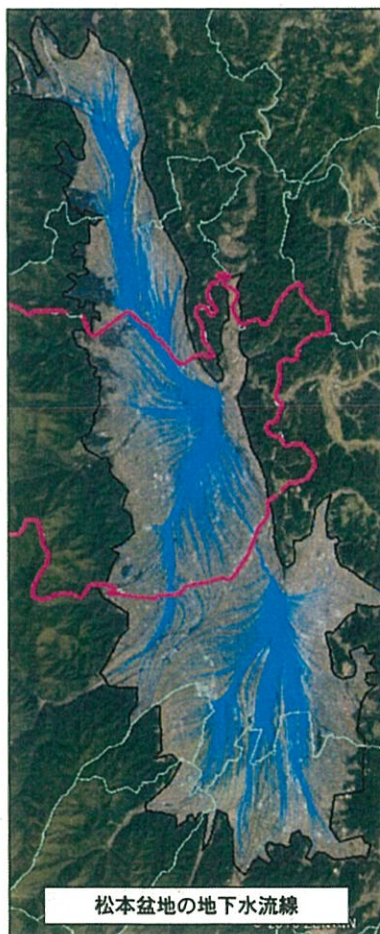
図 2.26 安曇野市水資源対策協議会による令和 2 (2020) 年度一斉測水結果に基づく地下水位等高線
